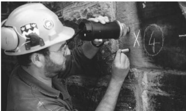
Figura 21.- Relación de distancia entre la fuente de impacto y el receptor. (Fuente: Afshin Sadri).
