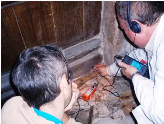
Figuras 17: Ensayos no destructivos (END) en elementos de madera: Escucha de sonidos para investigar la actividad de insectos xilófagos (izq.) e inspección de huecos a través de endoscopio (dcha.): Cortesía de Montañesa de desinfección, S.L.
