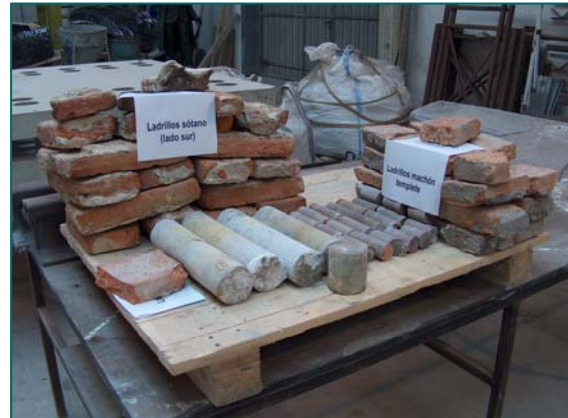
Figuras 16: Extracción de testigos de piedra de un sillar de un muro portante y preparación de muestras de materiales para su ensayo en laboratorio.
