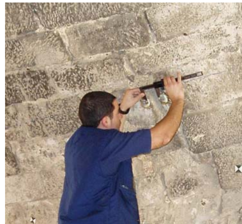
Medición de referencias mediante calibre
