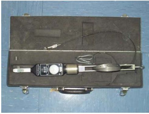
Cinta métrica indeformable: Equipo e instalación para lectura
