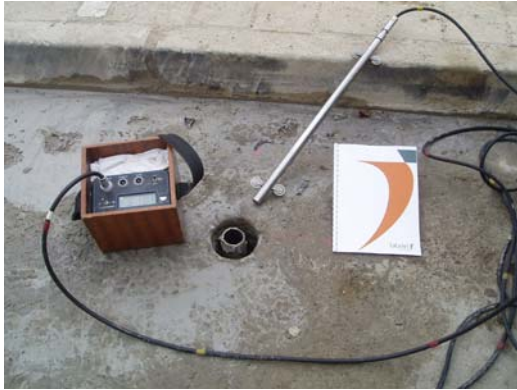
Tubo ranurado y torpedo inclinométrico con electrónica de medida.
