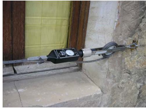
Cinta métrica indeformable: Equipo e instalación para lectura
