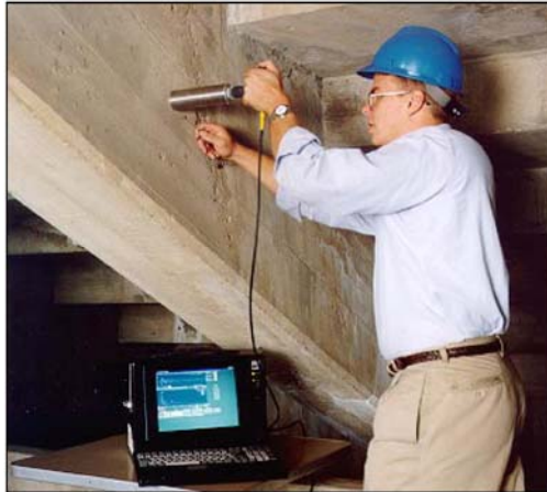
Figura 18.- Ejemplo del equipamiento de un ensayo de impacto-eco basado en un PC portátil. (Fuente: Nicholas J. Carino).
