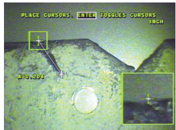
Medición de daño con equipos de endoscopia de última generación.
