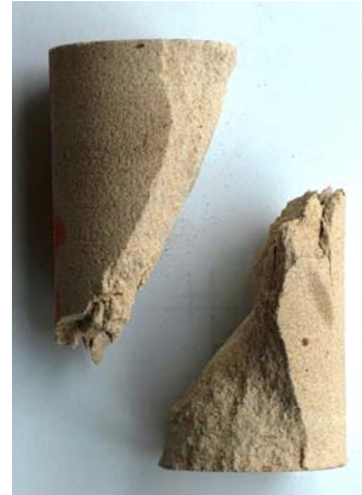
Figura 6.- Forma de rotura típica a 45°. Cortesía de LADICIM.
