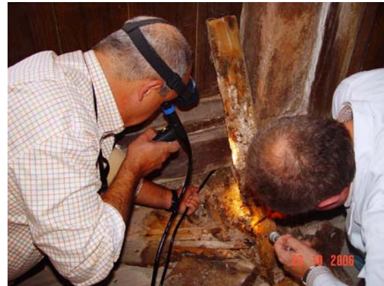
Figuras 17: Ensayos no destructivos (END) en elementos de madera: Escucha de sonidos para investigar la actividad de insectos xilófagos (izq.) e inspección de huecos a través de endoscopio (dcha.): Cortesía de Montañesa de desinfección, S.L.
