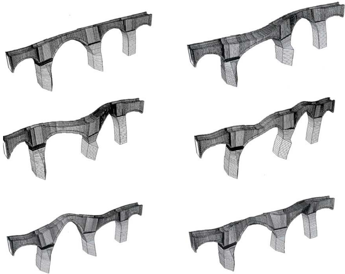
Figura 9. Modos de vibración obtenidos mediante análisis modal de vibraciones a partir de un modelo preparado para el Puente de Periques en Puig-Reig (Barcelona).
