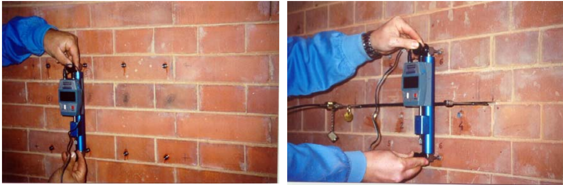
Ensayo para la estimación de nivel tensional.
