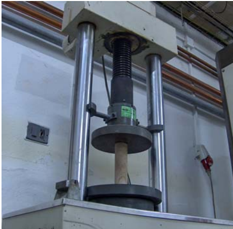
Figura 5.- Rotura a compresión de una arenisca. Cortesía de LADICIM.
