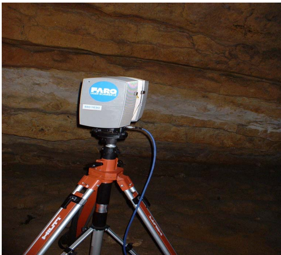
Figura 1: Sistema de medición del Láser Escáner 3D
