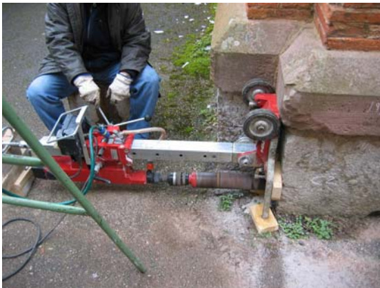
Figuras 16: Extracción de testigos de piedra de un sillar de un muro portante y preparación de muestras de materiales para su ensayo en laboratorio.
