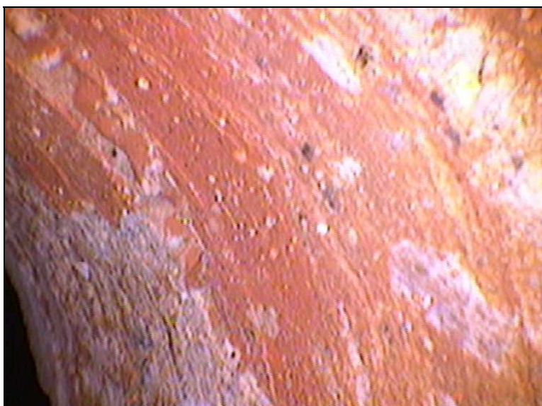
Endoscopia realizada en perforación del Testigo T2 en el forjado del coro, donde se distingue el mortero con fragmentos cerámicos.
